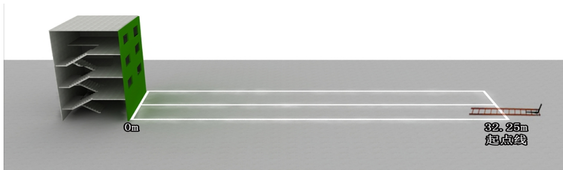
图 2 攀登挂钩梯场地器材设置示意图
